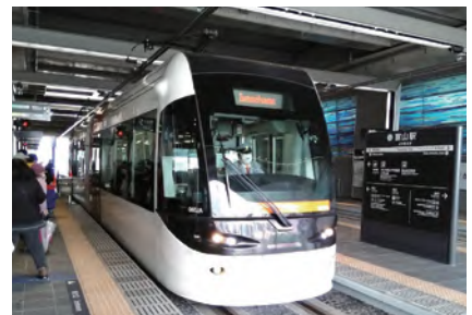
↑新幹線と間近に連絡し、富山駅南北を結ぶLRT車両
